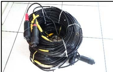
Fig. 17: Cable de refracción sísmica con 15 m de espaciamento
