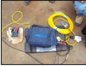
Fig. 15: Instalación del Geode
