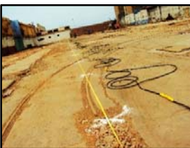
Fig. 07: Cable de Refracción Sísmica
