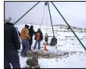
Fig. 09: Generación de ondas con equipo SPT
