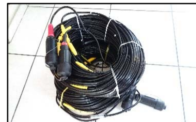
Fig. 15: Cable de refracción con 5 m de espaciamento entre geófonos
