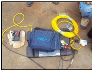
Fig. 13: Instalación del Geode
