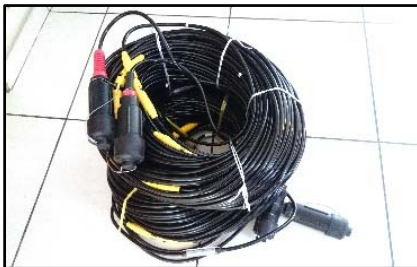
Fig. 15: Cable de refracción sísmica con 15 m de espaciamiento
