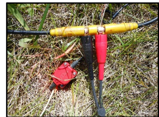
Fig. 12: Conexión del Geófono al cable de Refracción
