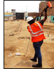
Fig. 14: Golpe del Martillo sobre el plato metálico
