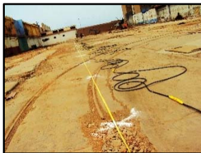
Fig. 05: Cable de Refracción Sísmica
