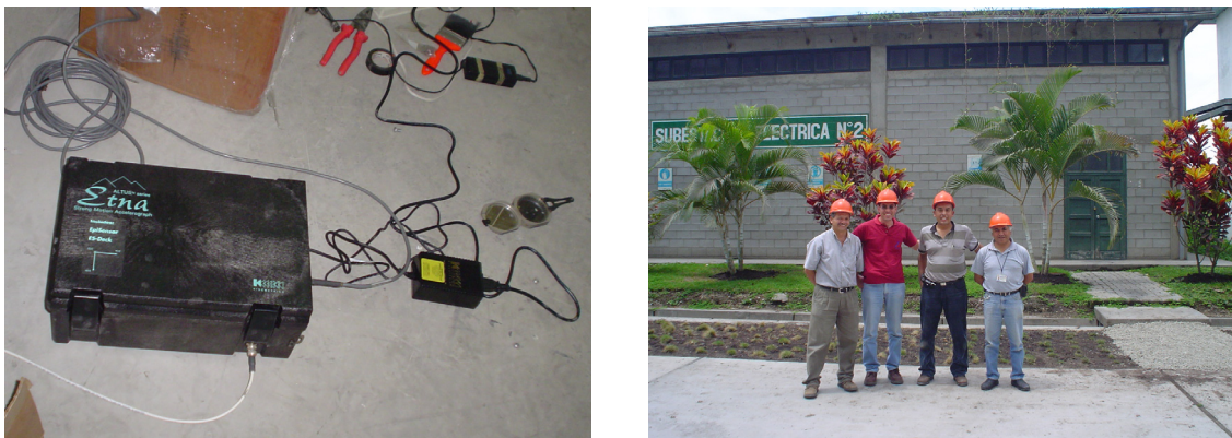
Figura10: Estación Acelerográfica Temporal, Planta de Cemento Selva
