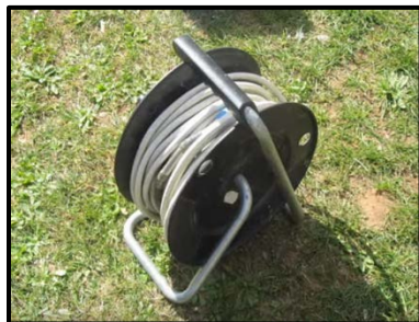
Fig. 5 Cable de resistividad eléctrica junto con el carrete
